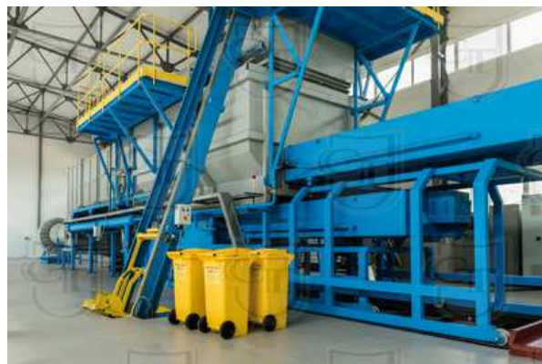
Установка утилизации медицинских отходов производительностью 200 кг/час. Система загрузки.
