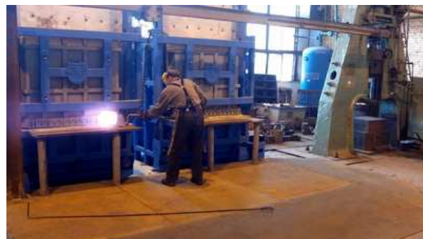
Кузнечные печи. Неподвижный под. Рекуперативные горелки. Температура 1260 °С.
