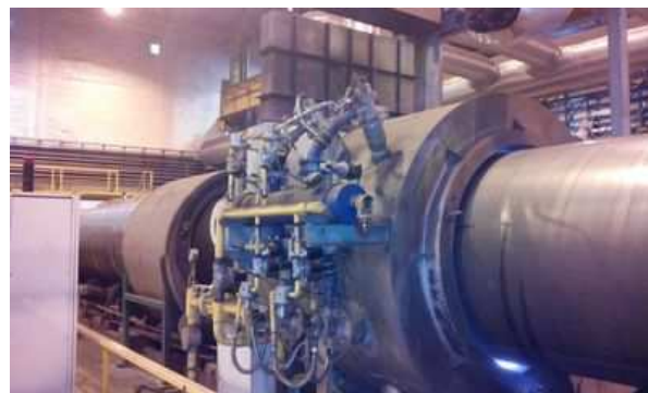
Печь сушки трубы диаметром до 1420 мм.
