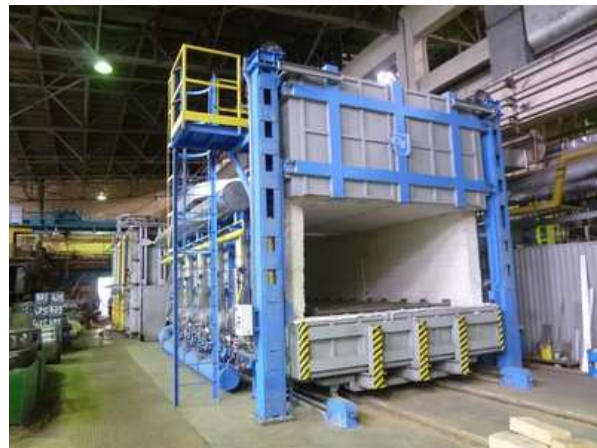
Термическая печь. Садка 60 т. Выкатной под. Исполнение для низких цехов. Рекуперативные горелки. Температура 1150 °С.
