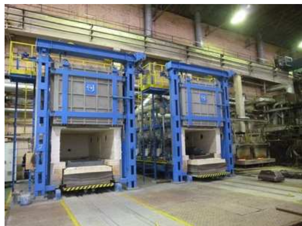
Нагревательные печи. Садка 20 т. Выкатной под. Рекуперативные горелки. Температура 1260 °С.
